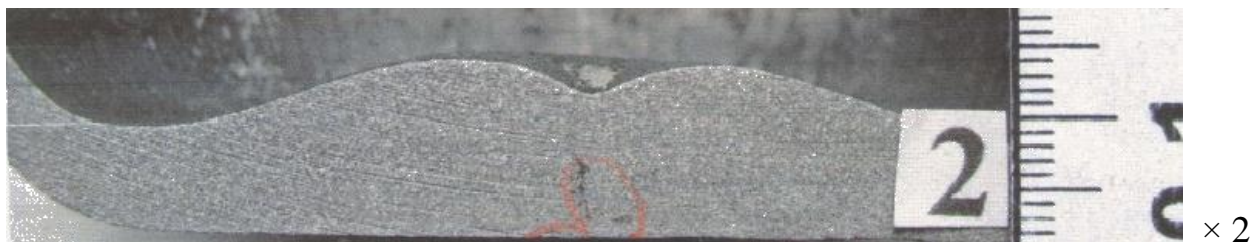
а – без підсадки; б – після підсадки на 15 %; в – після підсадки на 30 % Рисунок 7 – Залишки осьових дефектів днищ з різним ступенем підсадки
